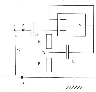
On note  $\underline{V}_e$  et  $\underline{I}_e$  respectivement l'amplitude complexe de la tension d'entrée  $v_e(t)$  et celle du courant d'entrée  $i_e(t)$ , en régime sinusoïdal forcé.
