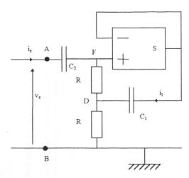
1. L'AO étant idéal, le courant dans la résistance située entre F et D est ie, et le potentiel de F est égal au potentiel de S. On en déduit en exprimant les tensions à l'aide des courants et des impédances complexes :
